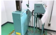
落下試験 運送中の落下による製品のダメージを想定して、規定に則った試験を実施し、結果をもとに梱包材や緩衝材の仕様を決定します。
