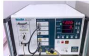
インパルスノイズ試験 電源に急激な電圧変動やノイズが起きたときに、製品が正常に動作し続けるかどうかを調べます。
