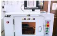
X線非破壊検査 外側からは判別することができない不具合をX線装置を使うことで発見することができます。
